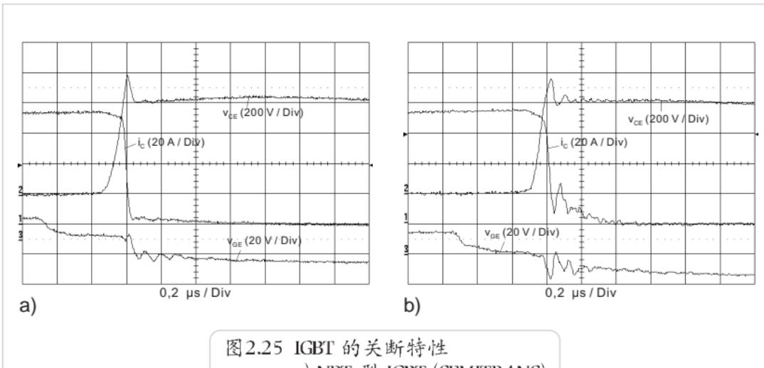
图 2.25 IGBT 的关断特性
