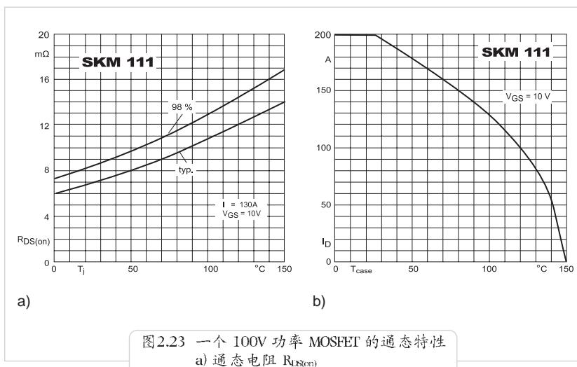
图 2.23 一个 100V 功率 MOSFET 的通态特性
